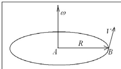
Выше мы определили понятие угла поворота из физических соображений. Однако, это можно сделать и из формальных математических соображений. Вращательное движение материальной точки по окружности радиуса  $r$  является плоским движением и может быть описано в двумерной прямоугольной декартовой системе координат  $(XOY)$ . В процессе движения материальной точки будут меняться обе координаты тела, уравнение траектории в данном случае будет представлено уравнением окружности:
