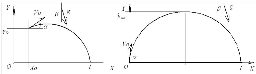
При движении в однородном поле, тело имеет постоянное ускорение, в данном случае – ускорение свободного падения. Запишем закон движения, для случая равноускоренного движения.
