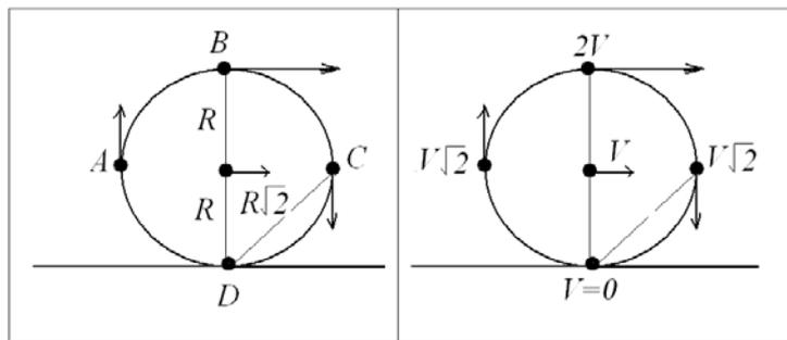
Перемещение любой точки обода колеса можно представить как вращение относительно оси, проходящей через точку  $D$ . Поэтому, скорость точки  $D$  равна нулю. Если скорость оси колеса, находящейся на расстоянии радиуса от точки  $D$  равна  $V$ , тогда скорость точки  $B$  равна  $2V$  (это следует из постоянства угловой скорости для всех точек колеса). Аналогично определяются скорости точек  $A$  и  $C$ .
